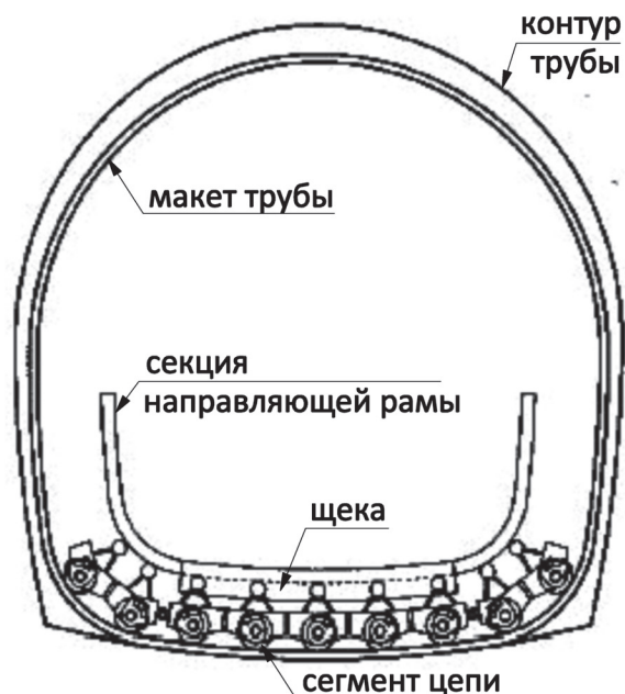
Рисунок 7 – Первый этап сборки навивочной машины
